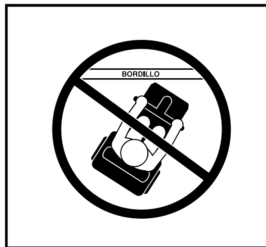
Figura 7. Modo incorrecto de subir/bajar un cordón
